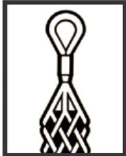
Hier sind drei Ziehstrümpfe aus verzinkter Stahllitze in einer Preßklemme zusammengefaßt und mit nur einer Öse verpreßt. Die Möglichkeit, drei Kabel einzeln zu erfassen - z. B. Einleiterkabel - und in einem Zugvorgang schonend einzuziehen, ist hierdurch gegeben.
